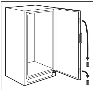
Прибор снабжен транспортировочными креплениями для фиксирования дверцы при транспортировке.
