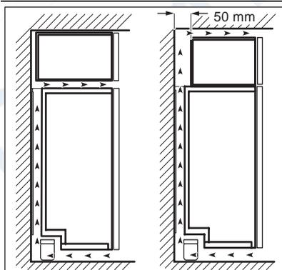
Если прибор расположен под подвесной мебелью, то для обеспечения оптимальной работы минимальное расстояние между верхом прибора и мебелью должно быть не менее 40 мм. Однако желательно вовсе не устанавливать прибор под подвесной мебелью. Вентиляционный зазор допускается:
