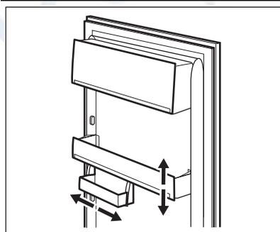
Чтобы обеспечить возможность хранения упаковок продуктов различных размеров, полки дверцы можно размещать на разной высоте. Чтобы переставить полку, действуйте следующим образом:
