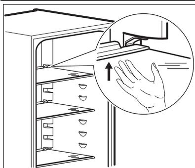
Расположенные на стенках холодильника направляющие позволяют размещать полки на нужной высоте.
