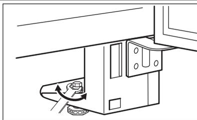
При установке прибора убедитесь, что он стоит ровно. При необходимости отрегулируйте ножки при помощи прилагаемого ключа.
