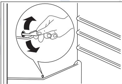
При нормальных условиях эксплуатации удаление инея с испарителя холодильной камеры происходит автоматически при каждом включении компрессора. Талая вода стекает через сливное отверстие в специальный поддон, установленный с задней стороны прибора над компрессором, а затем испаряется. Необходимо регулярно прочищать сливное отверстие, находящееся в середине канала холодильного отделения, во избежание накопления воды и попадания капель на находящиеся внутри продукты.
