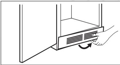
Чтобы помыть вентиляционную решетку, ее можно снять.
